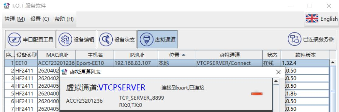
Step 3: PC 再次建立一个 TCP Client, 目的 IP 填写 PC 的 IP, 目的端口填写创建的透传通道, 即可以实现数据的收发。
