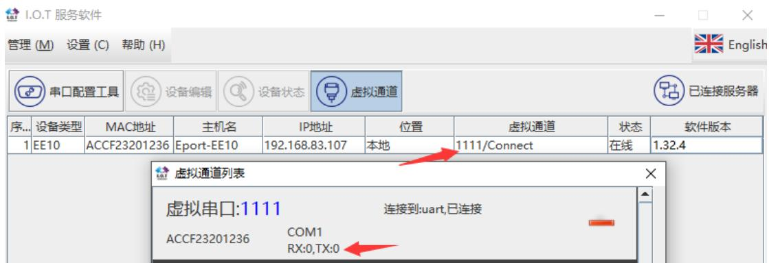
■ 已连接服务器: 工具连接到IOTBridge服务器的状态, 已连接状态才可查看到IOTBridge账户下的对应设备。
