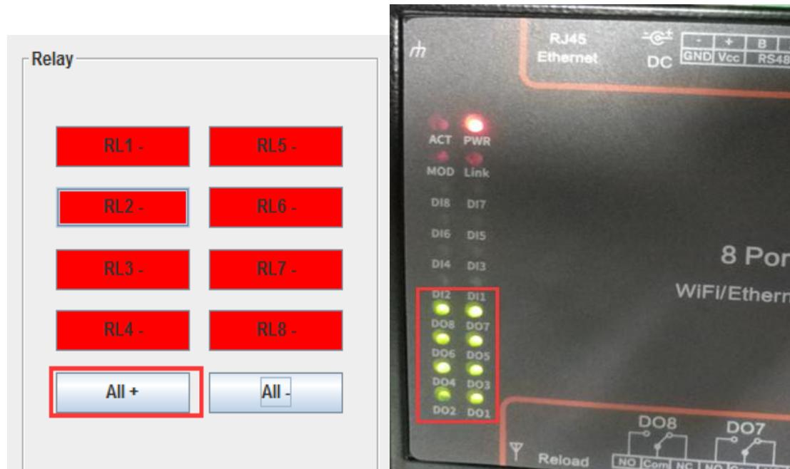
Step 6 DI 测试。后续只是为测试案例，不作为实际应用。可将设备 DO1 与 DO2 接入到 DI6 与 DI7 上，然后可以通过控制继电器 RL1 和 RL2 来查看 DI 6 和 DI 7 输入状态。
