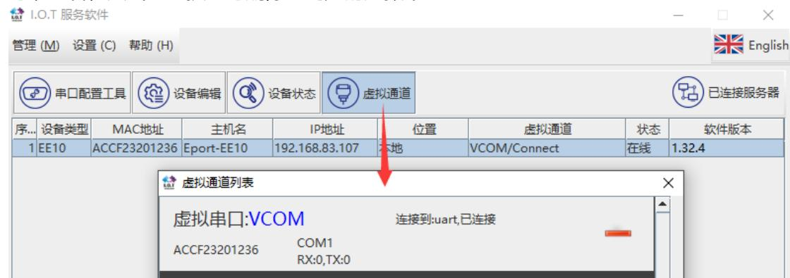
虚拟通道占用连接资源，可看到连接中有一个刚刚创建的虚拟串口信息。
