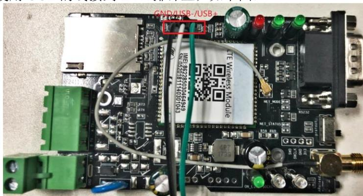
注：USB 线的绿色接 HF2411 的 USB+，白色线接 USB-，黑色接 GND。
